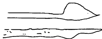
图 19 导线火烧熔痕示意图
