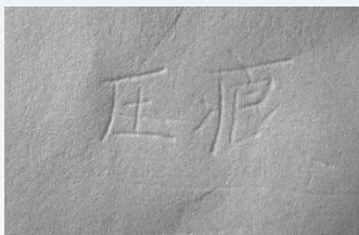
侧红外光源下纸张压痕显像
