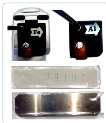
涡电流扫描仪由主机，两个扫描头及两个测试样组成，分别用于对深度篡改的铁磁性材料结构及非铁磁性材料（如铝合金）结构进行深入的非破坏性检验，它可以提高钢号检验仪的功能，使VIN码信息、篡改痕迹以及原始号码得以更加清晰的显现。
